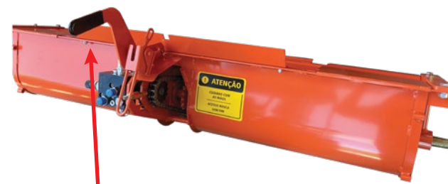
Alavanca de inspeção
